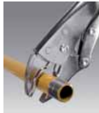
Mordazas grip: se utilizan para trabajos de sujeción para amordazar piezas durante el montaje y soldadura.
