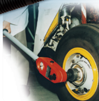
Um torquímetro DDS em uso na inspeção dos rolamentos das rodas de um avião da British
