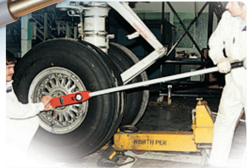
Um torquímetro EDS sendo usado na montagem da barra da roda (do nariz) de um avião Boeing
