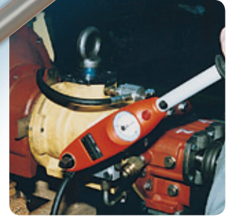
Caixa de câmbio sendo inspecionada por um torquímetro BDS
